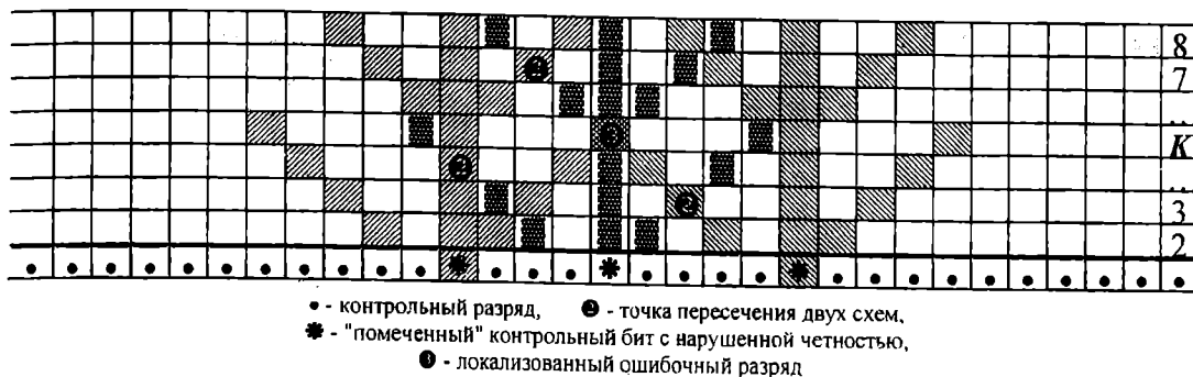
Рис. 1. Схема локализации ошибочного бита
